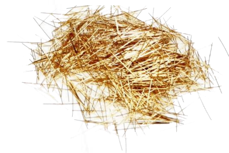
Стальная фибра L_f = 14 \text{ мм}
