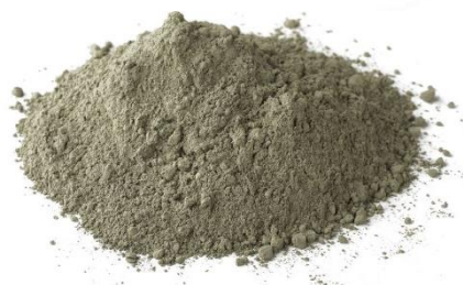
Сухая смесь D_{max} = 0,63 \text{ мм}
